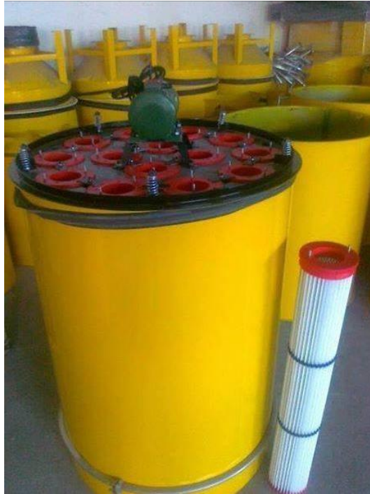
Hình 4. 8. Hệ thống lọc bụi silo
